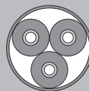
konventioneller Aufbau symmetrischer Kabel
