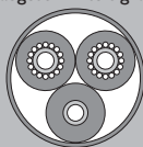
konventioneller Aufbau symmetrischer Kabel
